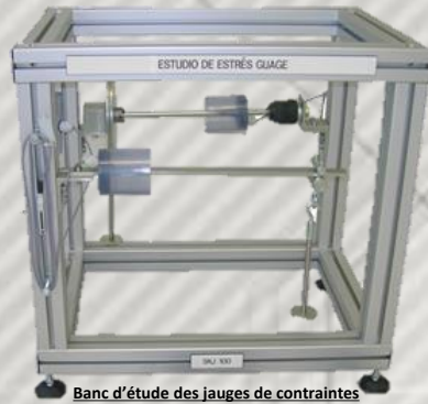
Banc d'étude des jauges de contraintes SKJ 100
