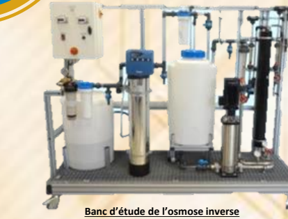
Banc d'étude de l'osmose inverse GPB OS1
